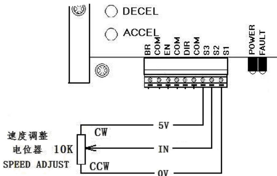
图 5 速度调节电位器的连接
