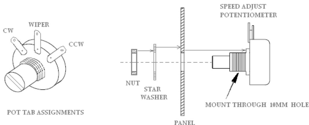
图 4 速度调节电位器的安装
