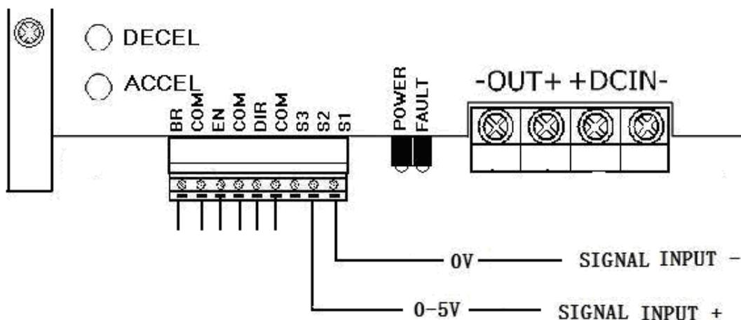
图 8 速度控制模拟量的连接
